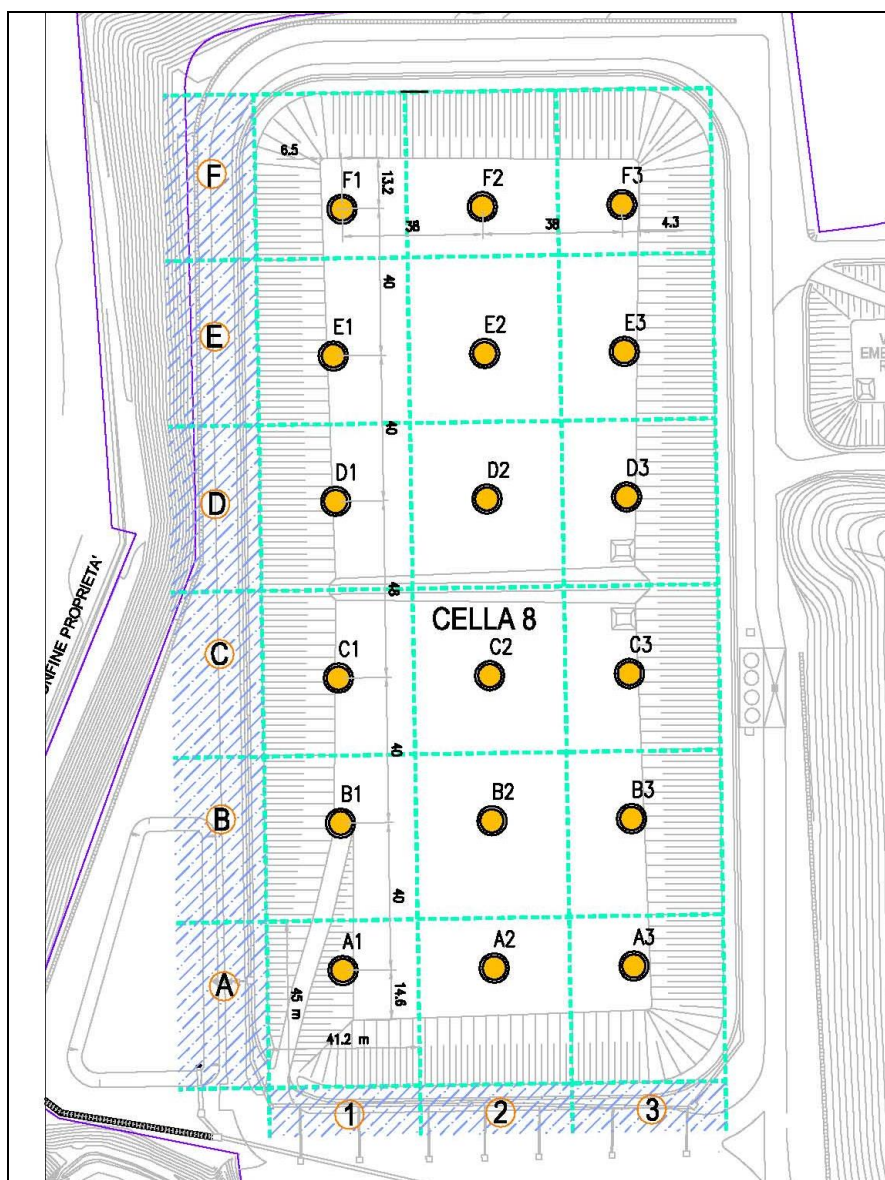
Figura 11 - Pozzetti di monitoraggio biogas nel corpo rifiuti
