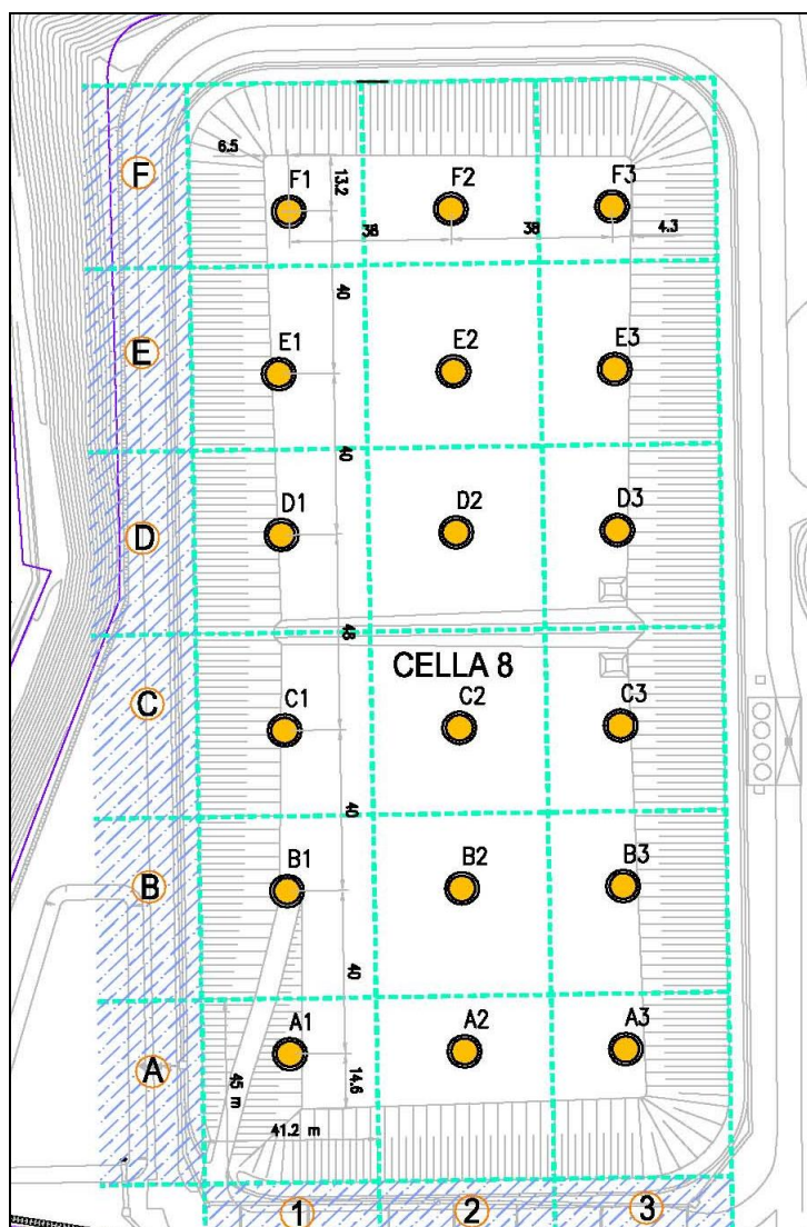
Figura 11 - Pozzetti di monitoraggio biogas nel corpo rifiuti
