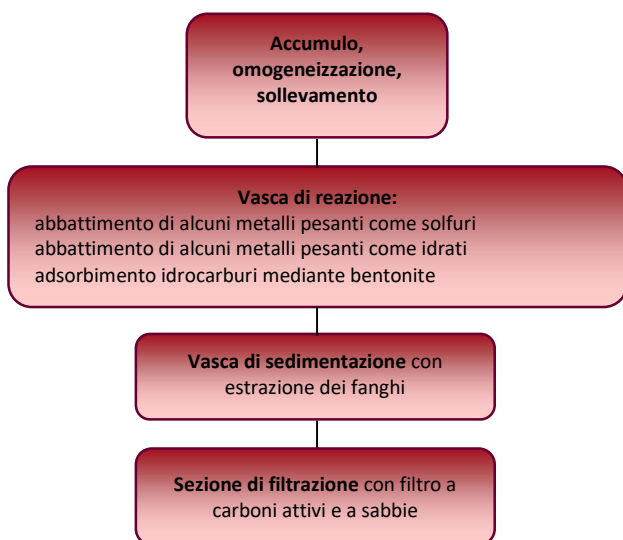
Figura 15: Schema del processo di depurazione
