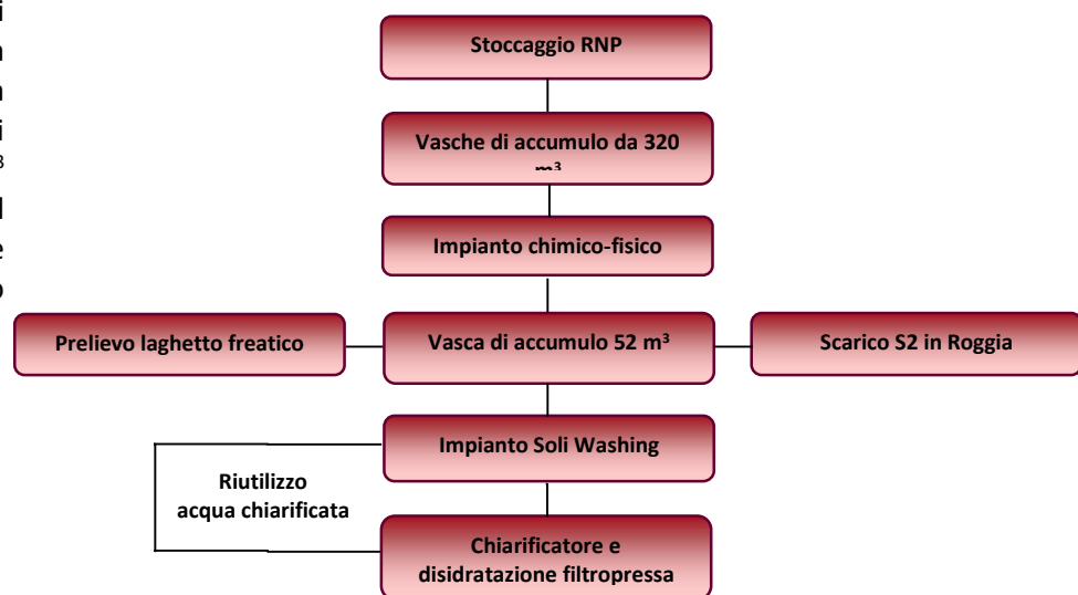
Figura 14: Schema di funzionamento sistema di raccolta acque settore OVEST
