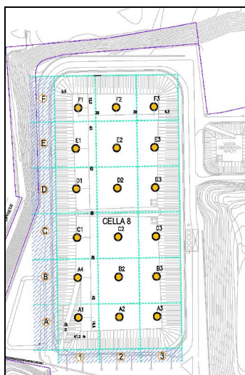
Figura 19: Pozzetti di monitoraggio
